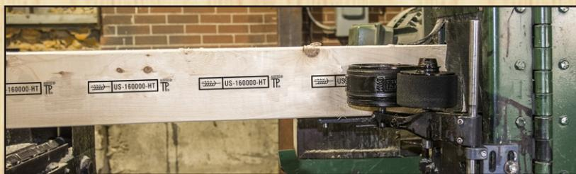
Pour les application à volume plus élevé marquage automatique fournit des impressions continues sans les nécessité d'une attention constant. Permet aux travailleurs d'effectuer d'autres tâches tandis que le bois est estampillé automatiquement. Peut être monté au-dessus, à côté, ou au-dessous de la ligne de production.
